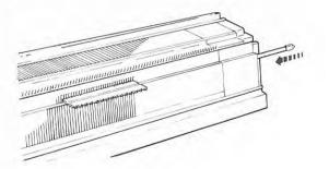
4. En repoussant les aiguilles à l'aide du pousse-aiguilles, introduisez la barre de retenue dans la fonture d'aiguilles.
