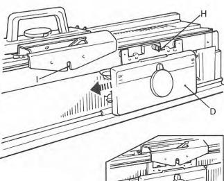
3. Déplacez lentement le chariot du côteleur vers le chariot de la tricoteuse jusqu'à ce que le goujon de liaison "H" sur le chariot du côteleur entre dans l'encoche "l" sur le bras.
