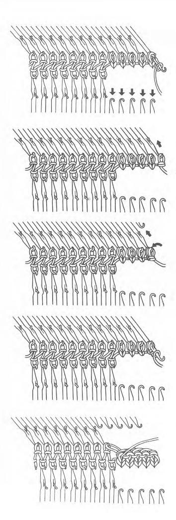
(4) Sur le côté du tricot où se trouve l'extrémité de la laine, avancez la première aiguille jusqu'à ce que ses mailles soient à l'arrière du loqueteau; enroulez l'extrémité de laine libre ainsi qu'illustré ci-contre.
