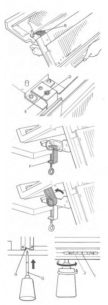
2. Tout en tenant le côteleur à deux mains, introduisez les plaques d'assemblage "B" du côteleur dans les entailles "C" situées aux deux extrémités de la tricoteuse.
