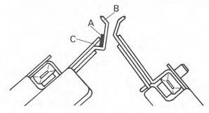
Avant d'effectuer la disposition des aiguilles, placez la baguette de montage serré "A" entre les chevilles "B" et le bord avant "C" de la fonture d'aiguilles de la tricoteuse.
