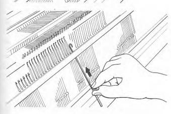
3. Pour mettre une nouvelle aiguille en place, glissez-la dans le sillon, le crochet en premier.
