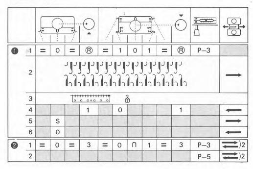
Si vous tricotez des côtes anglaises déviées à l'aide de toutes les aiguilles, changez le réglage de l'indicateur de direction au tableau de réglages de P-3 à H-3 et de P-5 à H-4.
