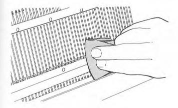
3. Frottez les languettes des aiguilles à loqueteau à l'aide d'un chiffon imbibé d'huile.
