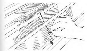
2. Avancez l'aiguille endommagée à la position D et, en la soulevant par la languette, retirez-la de son sillon.
