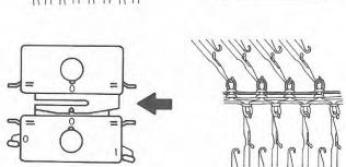
—6 Réglez à nouveau le levier de came à 0 et passez le chariot de droite à gauche. (Les aiguilles de la tricoteuse tricotent alors le troisième rang.)
