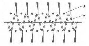
Effectuez les réglages inscrits au N° ● - 1-3 du tableau de réglages ci-dessus. Tricotez 1 rang et suspendez le peigne de montage de sorte que ses dents "A" soient vis-à-vis les chevilles "B" de la tricoteuse, ainsi qu'illustré.
