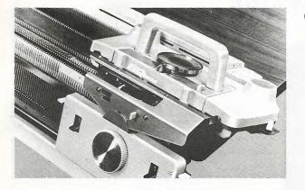
(4) Ayant placé le levier moteur en position de repos, aligner les aiguilles en position B en déplaçant le chariot plusieurs fois d'un côté à l'autre de la fonture d'aiguilles, et en l'arrêtant du côté droit.
