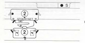
(6) Dégager le chariot du côteleur hors du bras en poussant le bouton de liaison. Pencher le chariot du côteleur vers l'avant et le placer du côté gauche, où le changeur de fil est installé. Régler le levier de came à SLIP (maille glissée). Retirer la couleur A du pince-fil et enfiler dans l'alimentateur de fil.
