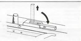
\* Lorsqu'il faut laisser le levier moteur au repos, relever légèrement des doigts et abaisser ainsi qu'illustré. (À la table de commandes, → indique la position au repos.)
