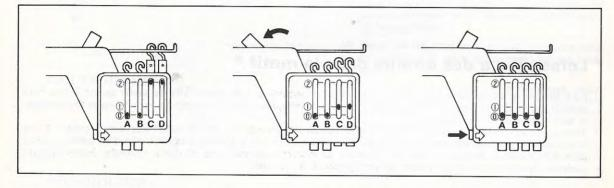
(2) Appuyer sur le bouton du porte-fil correspondant au fil dans l'alimentateur de fil et régler à ①. En déplaçant le levier d'entraînement vers la gauche, changer la position du porte-fil de ① à ②. Appuyer sur le bouton du porte-fil pour faire alterner le fil.
