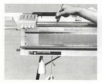
(11) Retirer les trois fils noués ensemble hors du pincefil et laisser tomber entre les deux fontures d'aiguilles. Introduire le crochet-accessoire par endessous et saisir les fils. Accrocher les fils aux poids suspendus sur le peigne de montage.
