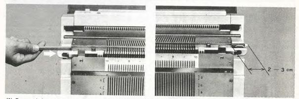
(1) Pousser la barre de retenue des aiguilles, à l'aide d'un tournevis ou d'un crayon, à partir de la gauche de la fonture d'aiguilles de la tricoteuse, jusqu'à ce que l'extrémité droite de la barre de retenue dépasse de 2 à 3 cms.
